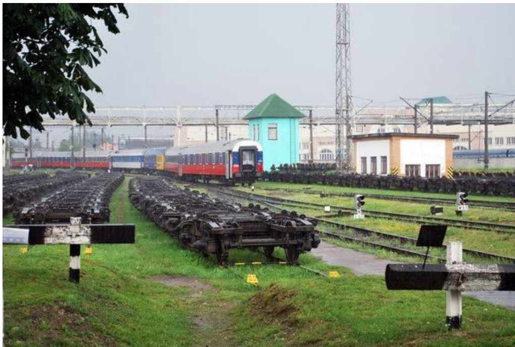
В Бресте из-за разницы в ширине железнодорожных путей между Белоруссией и Польшей под международными вагонами меняют колесные пары.
